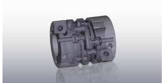
Sorgfältige Lamellenanbindung über Passschrauben und Präzisionsbuchsen
