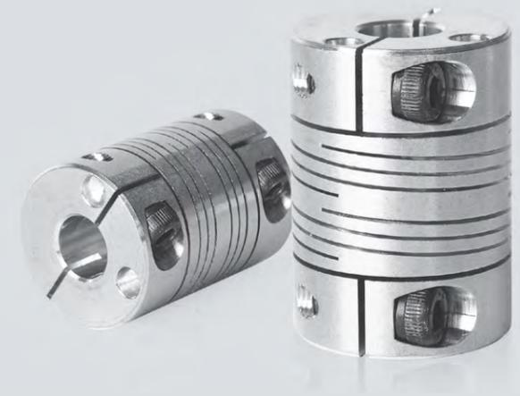
bietet die dritte Bauserie [Beamflex Encoder](#) geringere Rückstellkräfte, führt aber auch zu einer Verringerung der Drehsteifigkeit und der Drehmomentübertragungskapazität.
