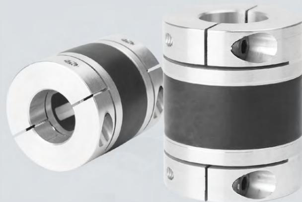
gungen gefordert ist. Sie vereint ein ausgewogenes Verhältnis aus Dämpfung und Drehsteifigkeit und ist je nach Baugröße für Drehzahlen bis zu 42.000 min<sup>-1</sup> ausgelegt. Das Funktionselement der Speedmax besteht aus dem synthetischen Polymer HNBR, einem hydrierten Nitril-Butadien-Kautschuk. Dieser umschließt im Inneren eine „fingerartige“ Nabenstruktur aus Aluminium, die von
