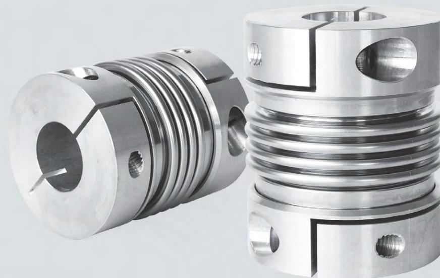
Kupplungen für Umgebungsbedingungen bis max. 100°C geeignet. Für höhere Temperaturanforderungen sind Balgkupplungen mit Schweißverbindungen ein Lösungsvorschlag, auf die später noch eingegangen werden. Ebenfalls für hohe Anforderungen an die Torsionssteifigkeit in Verbindung mit einer massenträgheitsreduzierten Bauform, durch teilweise abgesetzte Klemmnaben, und einer robusten Bauweise steht dem Anwender die Baureihe [Diskflex](#) zur Verfügung.
