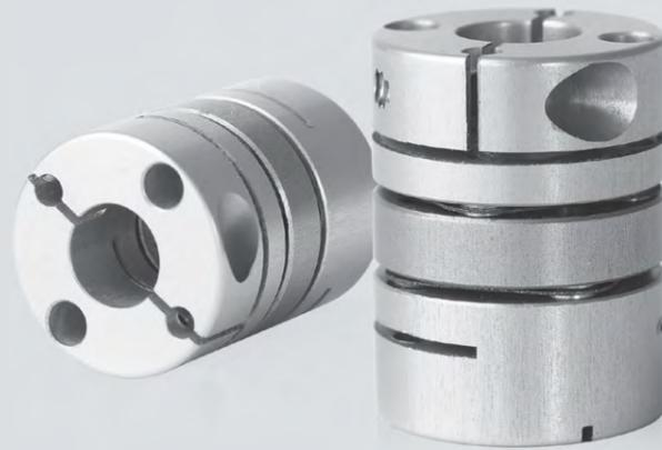
Die Miniaturlamellenkupplungen der Serie [Diskflex](#) werden meist in dynamischen Servosystemen eingesetzt. Die Naben, sowie die Zwischenstücke bei doppelkardanischen Ausführungen sind aus Aluminium gefertigt. Dadurch besitzen die torsionssteifen Ausgleichskupplungen ein geringes Massenträgheitsmoment, was sich vorteilhaft bei den mit hohen Beschleunigungs- und Verzögerungs-
