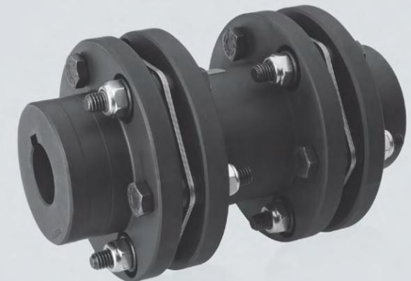
mentübertragung und Torsionssteifigkeit zeichnen sie aus. Das Programm umfasst Kupplungen in einem Nenndrehmomentbereich bis zu 65.000 Nm. Je nach Baugröße stehen sie für Drehzahlen bis zu 14.500 min<sup>-1</sup> zur Verfügung. Diese Kupplungen eignen sich zusätzlich für einen vertikalen Einsatz. Hierzu wird das Zwischenstück gestützt, damit die Lamellenpakete nicht belastet werden.
