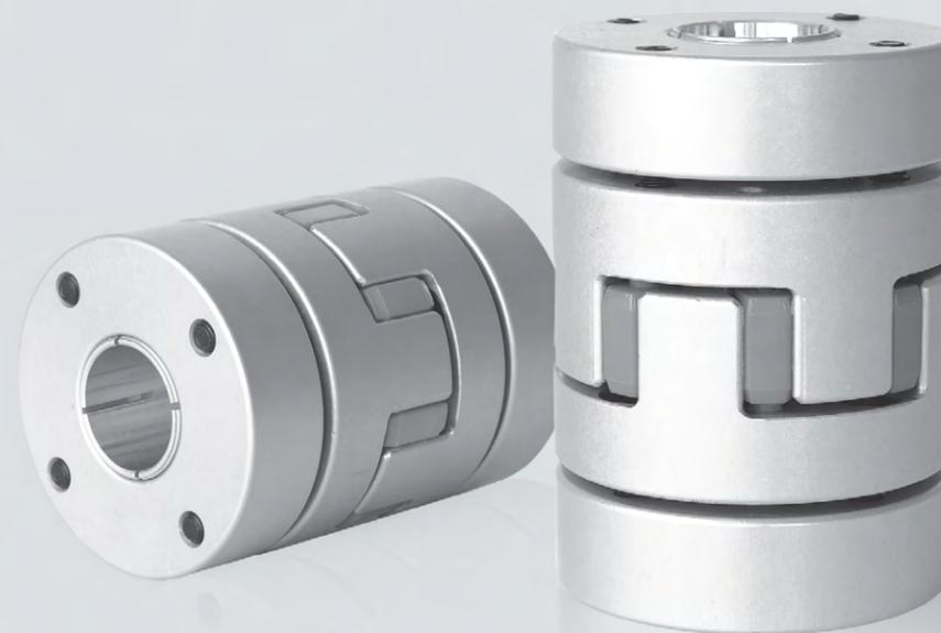
Schrauben ausgestattet. Zur Erzielung eines niedrigen Massenträgheitsmoments sind die Naben sowie das Konussystem der Kupplungen aus Aluminium gefertigt. Durch ihren symmetrischen Aufbau bieten die Elastomerkupplungen eine hohe Rundlaufgenauigkeit und eignen sich für den Einsatz in hohen Drehzahlbereichen, beispielsweise in Hauptspindeln von Werkzeugmaschinen.
