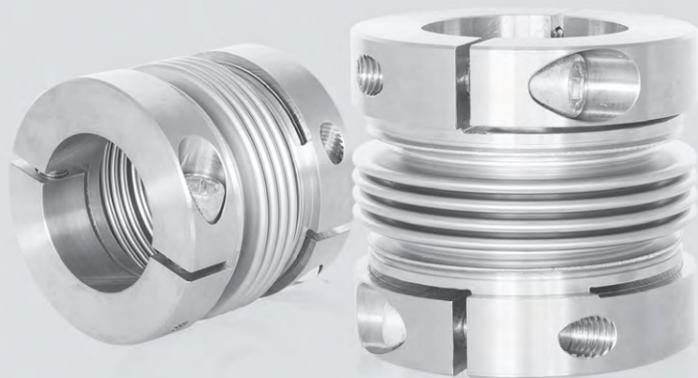
Mit der Modellreihe [Belflex Thermbago](#) steht dem Anwender ein Kupplungsprogramm für Vakuumanwendungen und Einsatzfälle in Hochtemperatur- oder aggressiven Medienbereichen zur Verfügung. Das Programm umfasst 12 Baugrößen und deckt einen Außendurchmesserbereich von 15 mm bis 101 mm ab. Das Funktionselement dieser Kupplungen ist ein Edelstahlbalg, der mit den Edelstahlnaben verschweißt ist.
